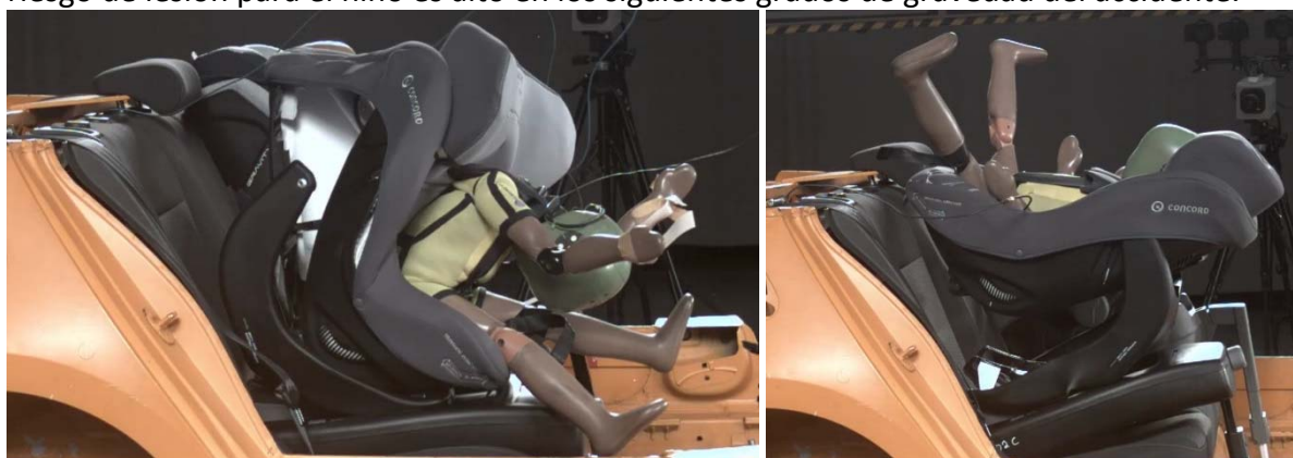
Figura 3: En el ensayo de impacto con la Concord Ultimax i-Size se rompe el armazón cuando va montado en el sentido de la marcha. A contramarcha, el armazón se sale de la base por la parte trasera (derecha).
