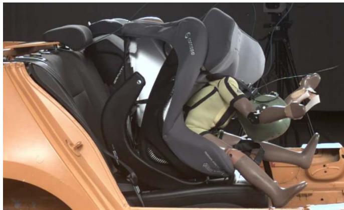
Figura 1: En el ensayo de impacto con la Concord Ultimax i-Size se rompe el armazón.
