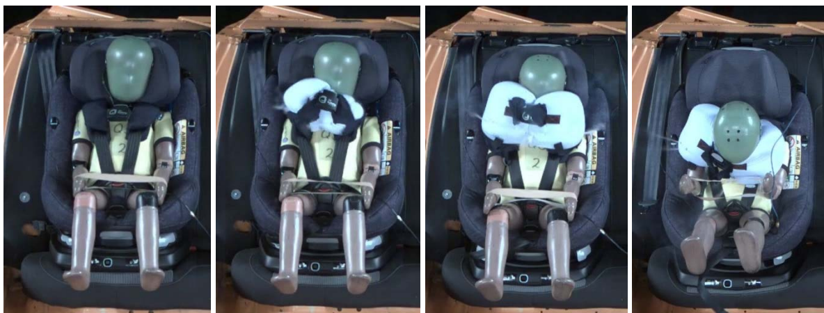
Figura 2: Maxi-Cosi Axissfix Air en el test de impacto frontal con el maniquí Q3
